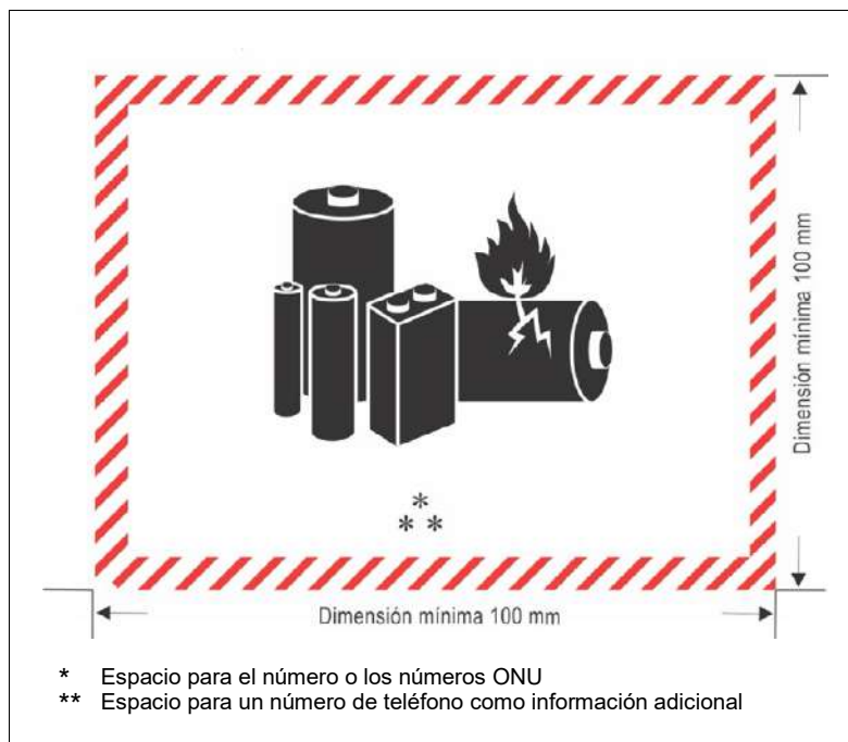
Figura 5-3. Marca de baterías de litio
